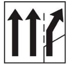
4.77.2 Freigabe des Pannenzustands
