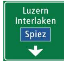
4.69 Einspurtafel über Fahrstreifen auf Autobahnen und Autostrassen
